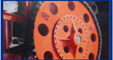
Sprocket para la Industria Azucarera en tres secciones con maza desmontable.
