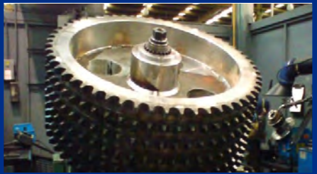
Sprocket séxtuple paso 240 de 56 dientes para enrolladora de Banda Transportadora
